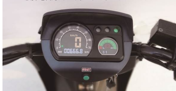
積算電流方式のオリジナルデジタルメーター
