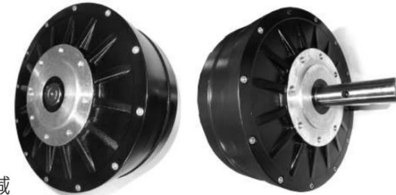
マグネットロータをステータコアの外側に配置したラジアルギャップ構造のアウトロータ型発電機です。
