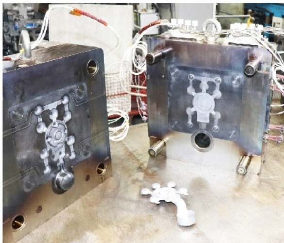
一部にグラファイト材を使った金型と試作品
